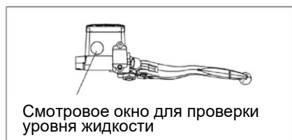
Рис. 28. Проверка уровня тормозной жидкости переднего тормоза
