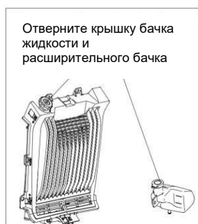
Рис. 35. Добавление охлаждающей жидкости
