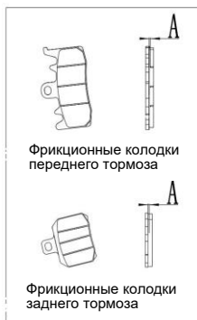
Рис. 31. Проверка фрикционных колодок заднего тормоза
