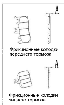
Рис. 27. Проверка фрикционных колодок переднего тормоза
