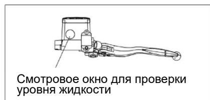
Рис. 32. Проверка уровня тормозной жидкости заднего тормоза
