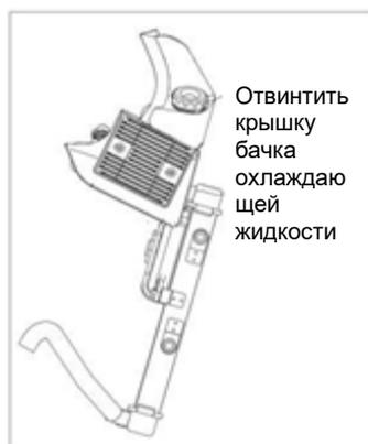
Рис. 34 Добавление охлаждающей жидкости
