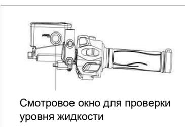
Разместите мотоцикл так, чтобы уровень тормозной жидкости в бачке находился в горизонтальном положении, и проверьте уровень тормозной жидкости через смотровое окно для проверки уровня жидкости (Рис. 27).
