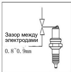
Рис. 18 Свеча зажигания
