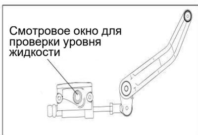
Разместите мотоцикл так, чтобы уровень тормозной жидкости в бачке находился в горизонтальном положении, и проверьте уровень тормозной жидкости через смотровое окно для проверки уровня жидкости.
