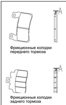
Проверьте минимальную толщину тормозных колодок (A).
