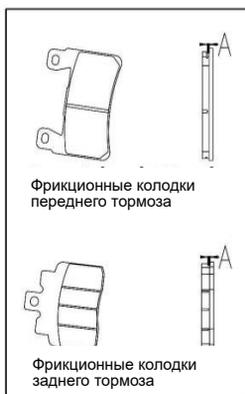
Проверьте минимальную толщину тормозных колодок (A).
