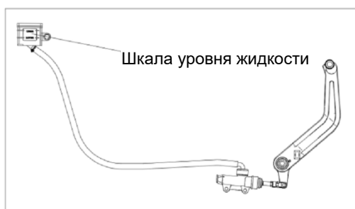
Рис. 37 Проверка уровня тормозной жидкости заднего тормоза
