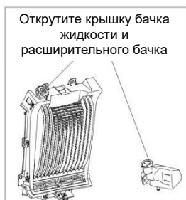
Рис. 41 Добавление охлаждающей жидкости
