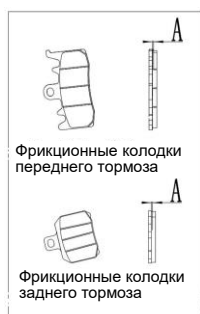
Рис. 32 Проверка колодки переднего тормоза
